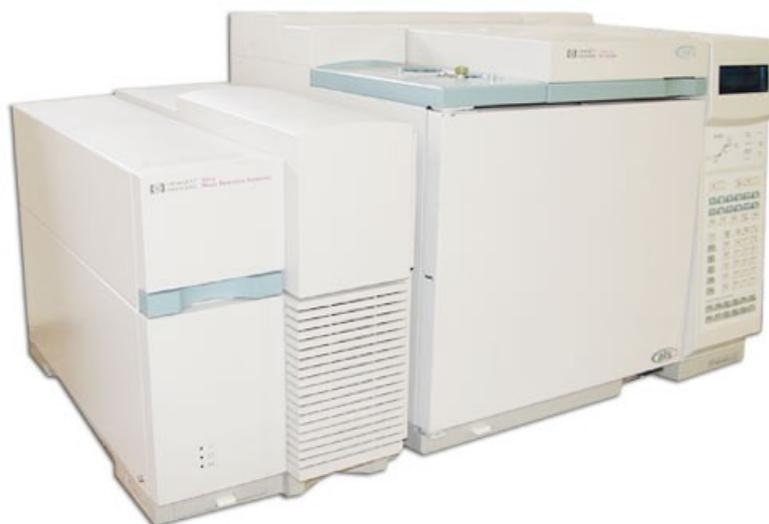
**Fig. 8** Gas-Cromatografo 6890 Plus, Spettrometro di massa 5973N (Agilent Technologies, Milano, Italia)
