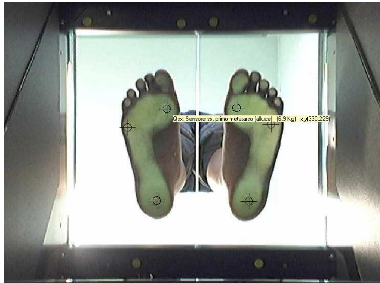
Figura 20. Posizionamento celle di carico.
