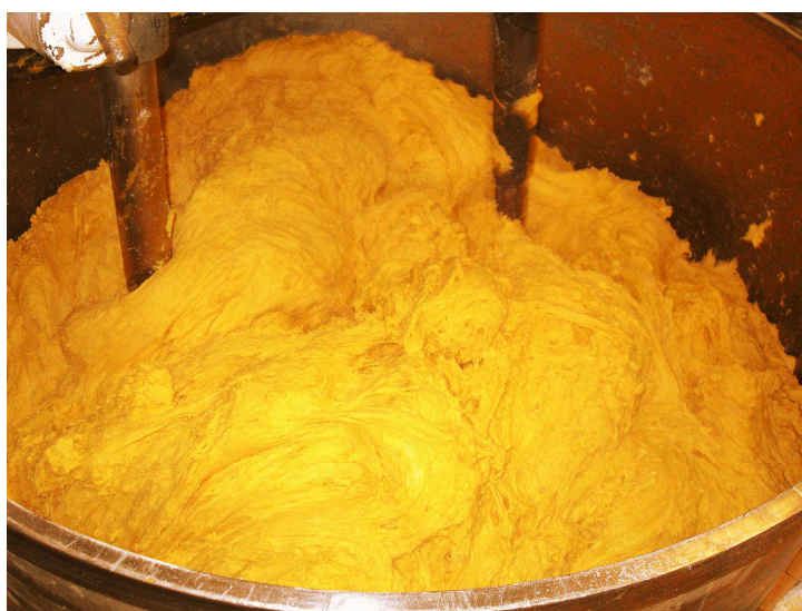
Foto2: Macchina impastatrice con braccia tuffanti all'interno dell'IDB Borsari.
